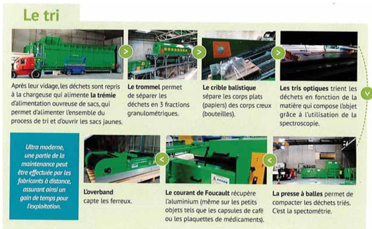
Après leur vidage, les déchets sont repris à la chargeuse qui alimente la **trémie** d'alimentation ouverte de sacs, qui permet d'alimenter l'ensemble du process de tri et d'ouvrir les sacs jaunes.
