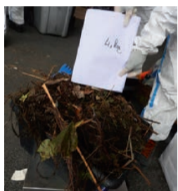
Tri de l'échantillon : les déchets sont déposés sur la table de tri et sont identifiés un à un pour être jetés dans le contenant adéquat
