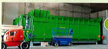
Après leur vidage, les déchets sont repris à la chargeuse qui alimente **la trémie** d'alimentation ouverte de sacs, qui permet d'alimenter l'ensemble du process de tri et d'ouvrir les sacs jaunes.
